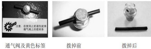
图 7、进口减速机膨胀油箱安装
