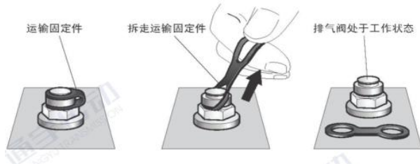
图 6、膨胀油箱安装示意图
